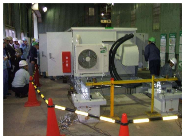
機器收容システム局舎載荷試験 (JFEテクノリサーチ株式会社)
