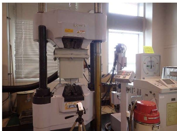
GFRP製基礎架台の圧縮破壊試験 (宮城県産業技術総合センター)
