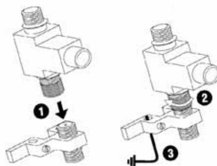
DGA GF TV接地取り付け部品
